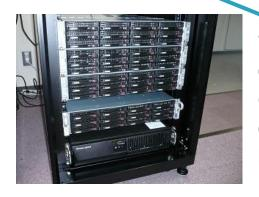
計算ノード数 12ノード、 ノードあたり 2CPU・48GBメモリCPU Xeon X5550(4コア)、 ネットワーク Gigabit+Infiniband DDROS/CentOS 5.3(Kernel 2.6.18-128.4.1.v.el5)
