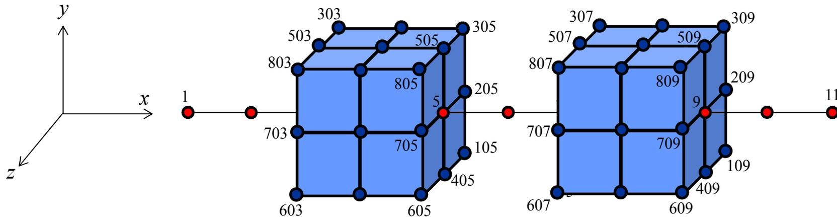
中立軸上の節点5の変位を  $(u_x, u_y, u_z)$  , 回転自由度を  $(\theta_x, \theta_y, \theta_z)$  とすると, 同じ断面上にある節点105, 205, 305, 405, 505, 605, 705, 805の変位  $(u'_x, u'_y, u'_z)$  を以下の式によって拘束する (ただし, 微小変形を仮定)
